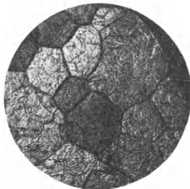
Fig. 93c. 90 Pt, 10 Ir nach L. Holborn, F. Henning und L. Austin. 2 Stunden lang auf 1500° erhitzt.
