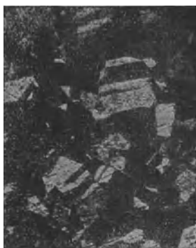
Fig. 9. 72× Vergr. Dasselbe Kupfer, wie in 8, jedoch 20 Min. auf 800° erhitzt, zeigt stärkere Rekristallisation.
