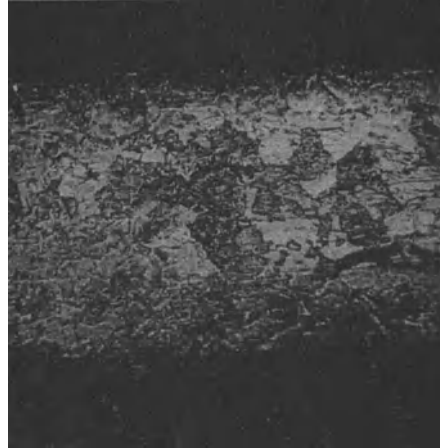
Fig. 4. Desgl. auf 500^\circ erhitzt, 120 fach vergr.; mit \text{HNO}_3 geätzt.
