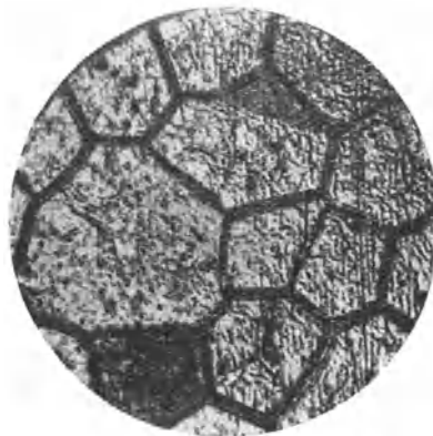
Fig. 93b. 90 Pt, 10 Ir nach L. Holborn, F. Henning u. L. Austin. 5 Stunden lang auf 1500° erhitzt.
