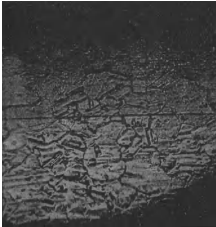
Fig. 5. Desgl. auf 800^{\circ} erhitzt, 120 fach vergr.; mit \text{HNO}_3 geätzt. (Nach F. Credner.)
