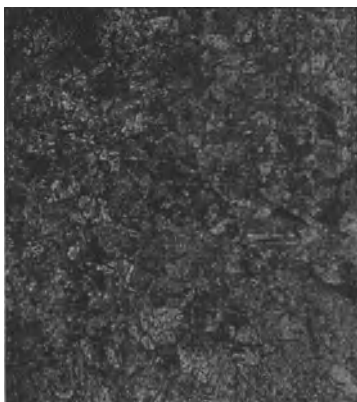
Fig. 7. 72× Vergr. Kupfer geschmolzen, durch hohen einseitigen Druck stark verfestigt. (Nach O. Faust.)
