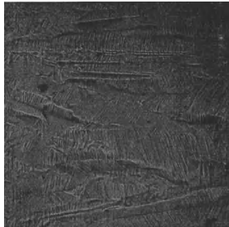
Fig. 6. Kupferstück (elektrolyt.) \uparrow Richtung der Kathode. \leftrightarrow Richtung der Pressung. 90 fach vergr.; nicht geätzt. (Nach F. Credner.)
