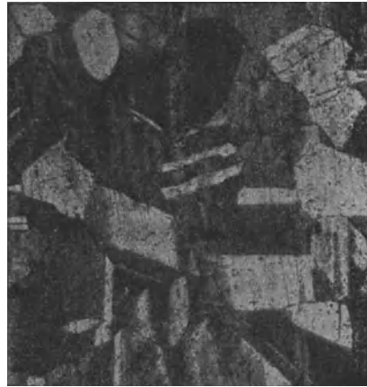
Fig. 11. 72 × Vergr. Dasselbe Kupfer, wie in den Bildern 7—10, 10 Sekunden auf 900° erhitzt, zeigt weiter fortgeschrittene Rekristallisation.
