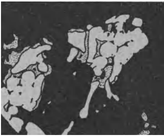
Fig. 72. Künstliches gediegenes Eisen mit Magnetkiesrelikten. Vergr. 235 (nach W. Eitel).
