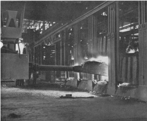
Abb. 45. Beschicken eines Siemens-Martinofens (Beratungsstelle für Stahlverwendung).
