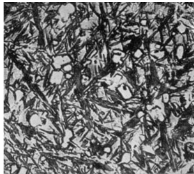
Abb. 33. Gefüge eines richtig gehärteten und auf etwa 600° angelassenen Schnellarbeitsstahles.
