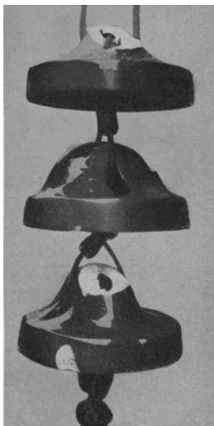
Abb. 14. Durch Überspannungen im Betrieb beschädigte Hewlettkette.
