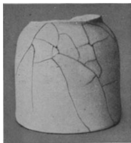
Abb. 3. Durch schroffen Temperaturwechsel auseinandergerissene Telegraphenglocke. (+ 100° C, — 20° C).
