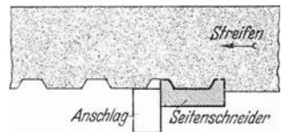
Abb. 106. Gezahnter Seitenschneider zur Bewegungsverriegelung.
