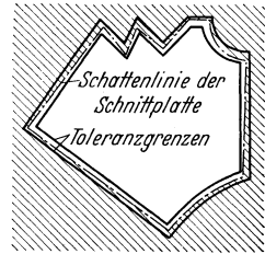
Abb. 3. Kontrolle einer Schnittplatte an den Toleranzlinien.
