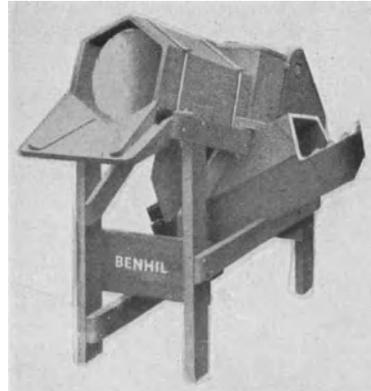
Abb. 4. Butterschnitzelmaschine von Benz & Hilgers.
