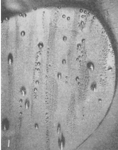
Abb. 102. Reine Tropfenkondensation an einer polierten und verchromten Kupferplatte.
