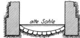
Abb. 82. Sohlenvertiefung unter einer Brücke. (Nach Krüger.)
