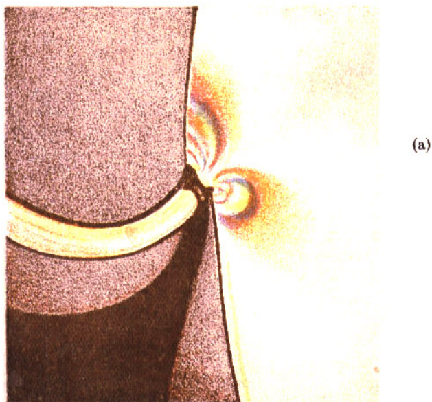
Фиг. 4.183а. Обточка диска хорошо заточенным резцом.
