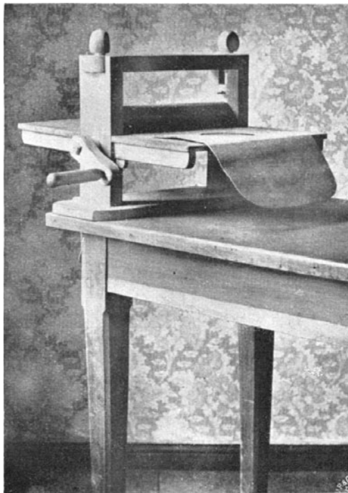
Abb. 64. Holzwalzen zum Glätten des Bleiblechs.
