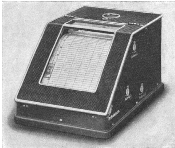
Abb. 33. Registrierendes Meßgerät zur selbsttätigen Aufzeichnung der Sekundendosis während der Bestrahlung.
