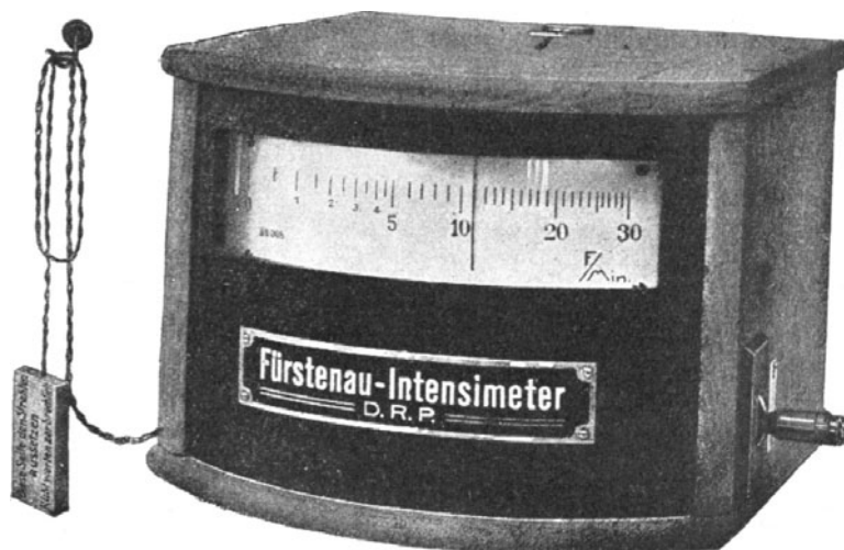
Abb. 27. Intensimeter nach Fürstenau. Normaltyp für Oberflächenbestrahlungen.
