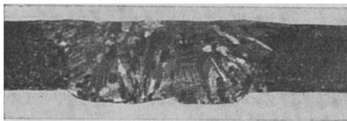
Abb. 339. Makroschliff einer elektrischen Aluminium-bronzeschweißung.
