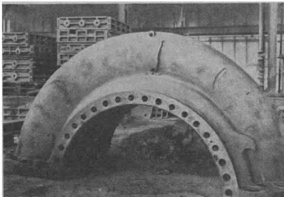
Abb. 303. Oberteil eines Spiralpumpengehäuses vor der Schweißung.
