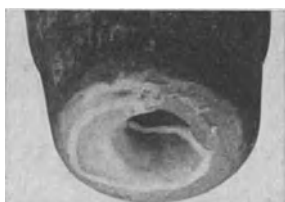
Abb. 335. Durch Schweißung ausgebesserte Hochofenwindndüse.
