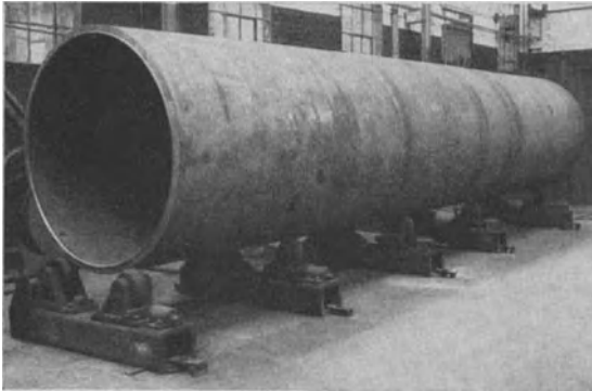
Abb. 231. Geschweißter Mantel eines Hochdruckkessels auf Rollenböcken.
