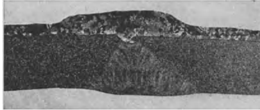
Abb. 308. Makroschliff einer Schweißnaht an kupferplattiertem Stahlblech.
