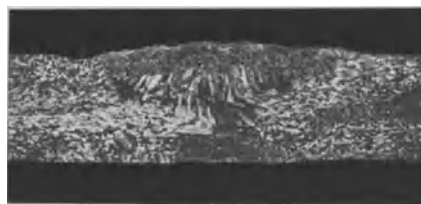
Abb. 344. Schliff einer Aluminium-Dickblechschweiße.
