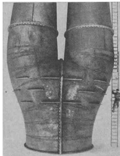
Abb. 213. Hosenrohrformstück für eine Turbine.
