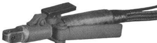
Abb. 141. Elektrodenhalter mit Zündkontakt.
