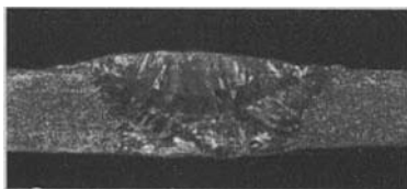
Abb. 333. Makroschliff einer mit der Schlauchelektrode hergestellten Kupferschweiße.
