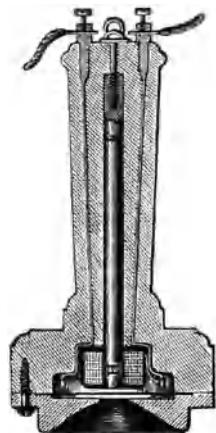
Abb. 9. Bells Telephon mit Stabmagnet. (Die Geschichte und Entwicklung des elektrischen Fernsprechwesens.)
