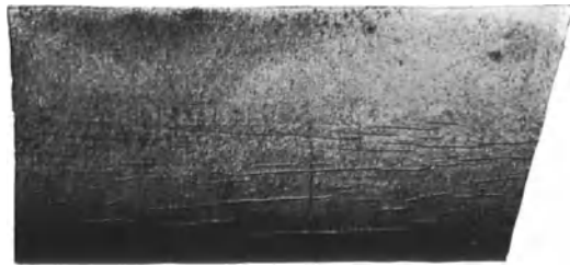
Abb. 95. Spannungsrisse durch zu schroffe Abkühlung nach Warmwalzen.
