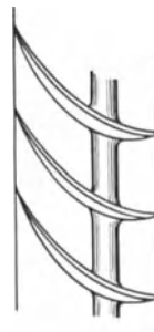
Abb. 115. Zu schwaches Schaufelprofil für hohe Beanspruchung.
