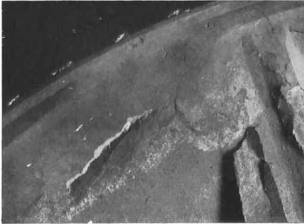
Abb. 133. Zwischenboden mit abgelösten Gußschalen.
