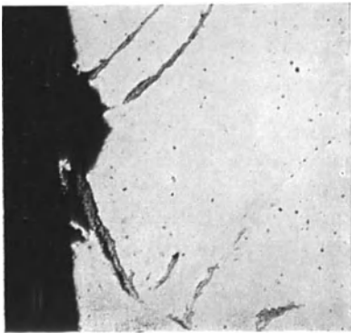
Abb. 92 und 93. Querschliffe der Längsrisse.
