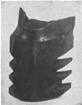
Abb. 29. Schwingungsbruch (im Betriebe erfolgt).
