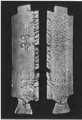
Abb. 57. Lauf- und Leitschaufeln aus 25% Ni-Stahl mit Querrissen.
