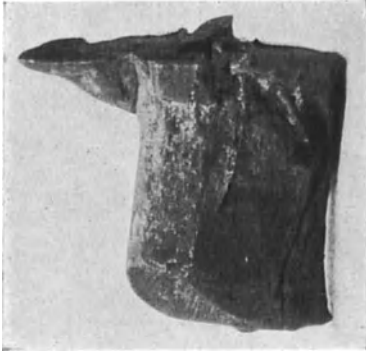
Abb. 108. Schlußstück aus Kupfer, aus der Befestigungsstelle herausgewachsen.
