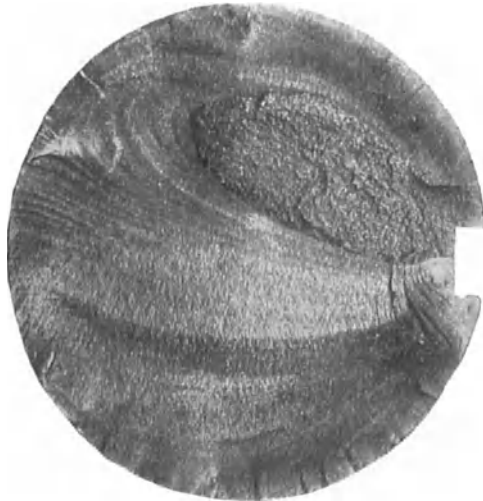
Abb. 27. Dauerbruch einer Lokomotivtreibkurbel.
