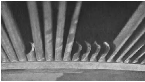
Abb. 121. Schaufeln aus 5 proz. Ni-Stahl, nach 3 Monaten Betriebsdauer gebrochen.
