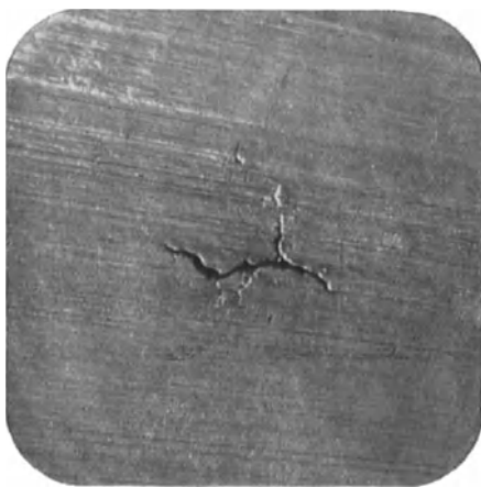
Abb. 86. Lunker im Walzknüppel.
