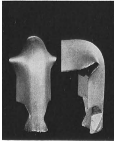
Abb. 58. Laufschaufeln aus 25% Ni-Stahl aus demselben Rade noch völlig unversehrt (zur Prüfung umgebogen).
