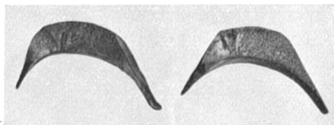
Abb. 28. Schwingungsbrüche (im Betriebe erfolgt).
