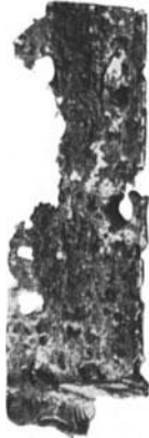
Abb. 39. Korrodierte Schaufel aus einer Turbine einer chemischen Fabrik.
