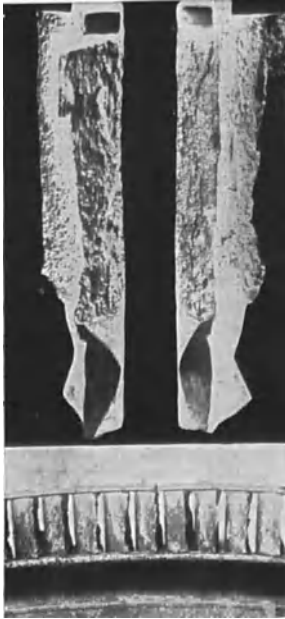
Abb. 127. Starke Korrosion an Bronzeschaufeln durch chemische Einflüsse.
