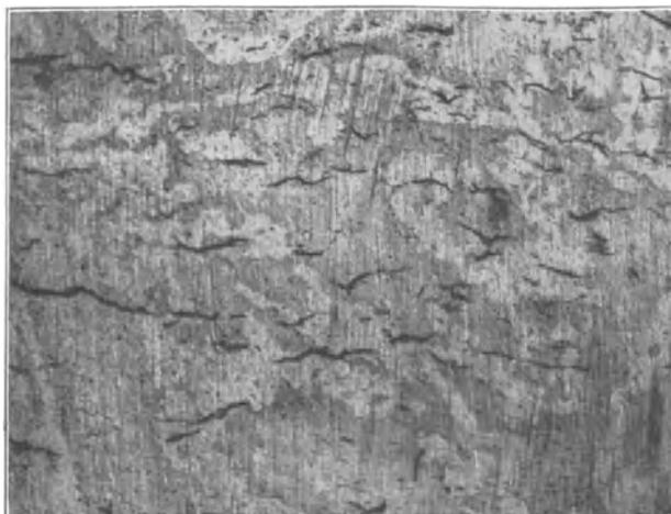
Abb. 70. Oberfläche eines Hohlkörpers mit Rissen (rund  $\times 2$ ) (Nehl).
