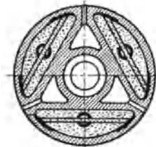
Abb. 7. Läufer mit pulverigem Widerstandsstoff von Thoresen.
