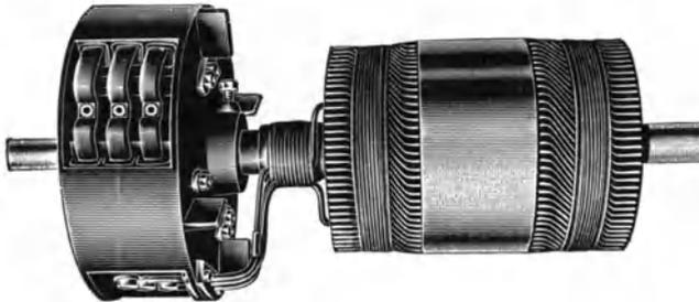
Abb. 29. Abbildung eines Läufers mit Dunker-Anlasser.
