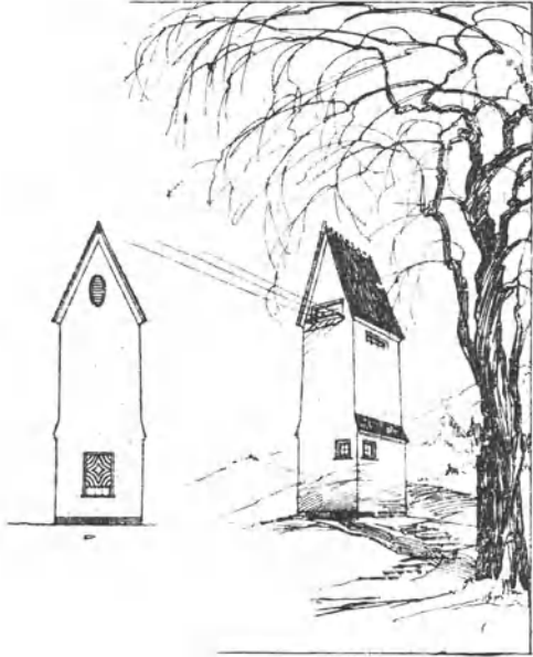
Abb. 39. Elbtalzentrale. Normale Station für Hochspannungseinführung und Niederspannungsabgang; Einführungsöffnung im Giebel, daher Höhenersparnis. Architekt: W. Issel, A.E.G., Berlin.
