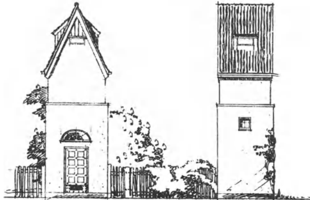
Abb. 40. U.C. Gotha. Kabelstation für Zella-St. Blasii. Niederspannungsausführung nach allen Seiten. Architekt: W. Issel, A.E.G., Berlin.
