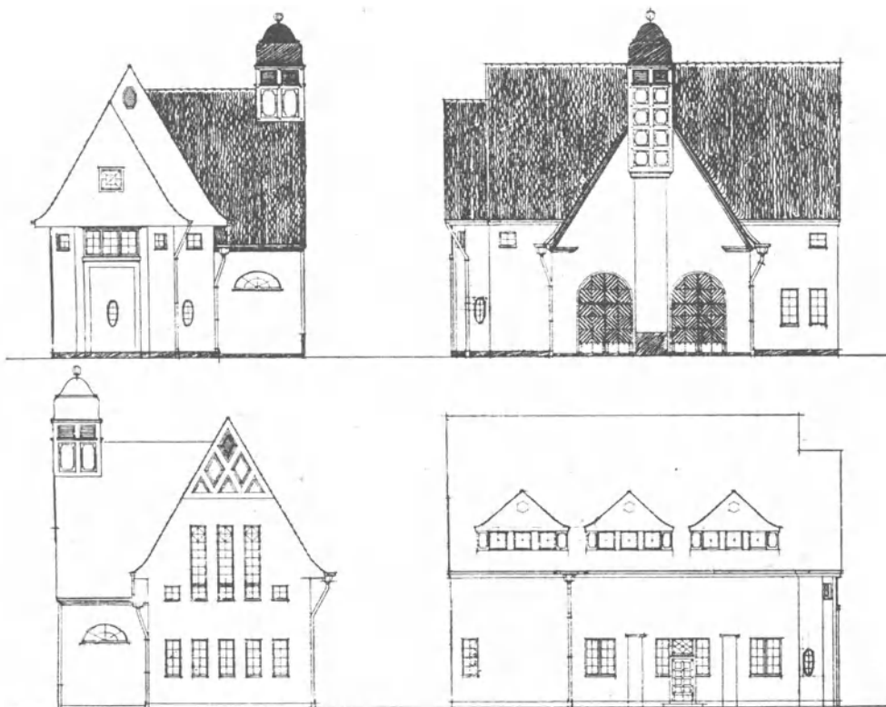
Abb. 21. U.C. Gotha. Unterstation Eisenach für 2 Transformatoren. Station ist in einer Vorstadt errichtet und deren Villencharakter angepaßt. Architekt: W. Issel, A.E.G., Berlin.
