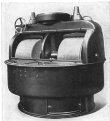
Abb. 27. Kollergangmischer mit sich drehendem Boden Stein und zwei Läufern aus Granit. Bauart Miag.
