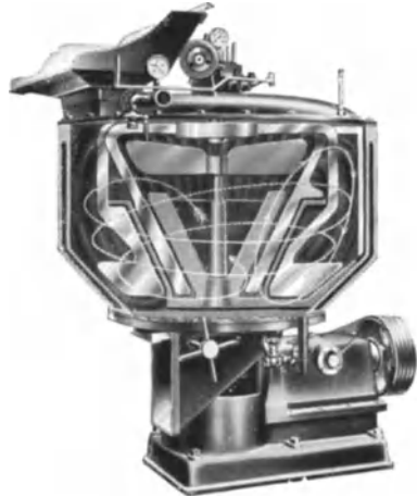
Abb. 34. Darstellung der Inneneinrichtung eines Kreiseldreiers. Bauart J. S. Petzholdt.
