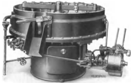
Abb. 36. Vorkühl- und Mischmaschine für weiche und flüssige Schokoladenmassen. Bauart K. Leopold Hildebrand.
