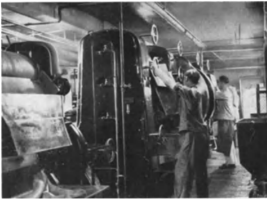
Abb. 31. Lehmann-Walzenstühle im Betrieb.
