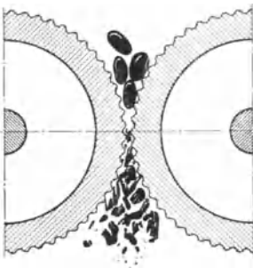
Abb. 11. Walzenbrecher für Kakaobohnen. Nach Herm. Bauermeister.
