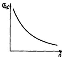
Abb. 13. Die Abhängigkeit der Durchschlagfeldstärke  $E_d = \frac{U_d}{\delta}$  von der Elektrodenentfernung.
