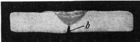
Abb. 73. Schlecht geschweißtes Flußstahlblech. *b* = nicht durchgeschweißt.
