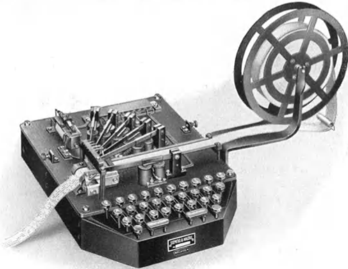
Abb. 40. Schreibmaschinenlocher von Siemens & Halske A.-G. mit a abgenommenem Schutzkastendeckel.
