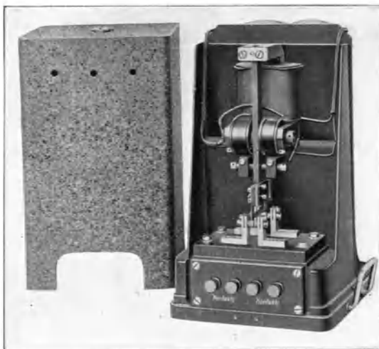
Abb. 30. Tastrelais von Telefunken.
