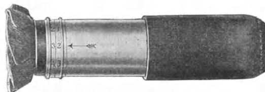
Abb. 5. Stadtröhrepostbüchse der Münchener Rohrpost.
