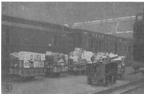
Abb. 1. Schleppzug mit Schlepper der Siemens-Schuckert-Werke.
