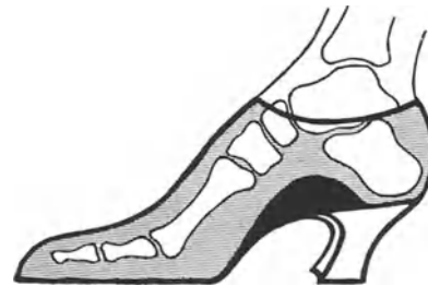
Abb. 101. Wie eine moderne Schuhfabrik sich die Lage der Fußknochen in ihren freilich orthopädischen Stiefeln mit besonderer Einlage für die Stützung des Fußgewölbes denkt. Die Knochenverbiegung erinnert in entferntem Grade an das Röntgenbild eines Chinesenfußes (Abb. 106).
