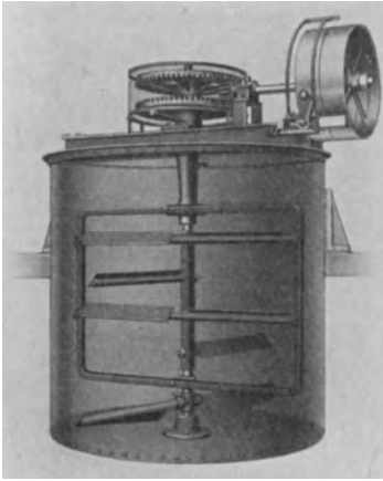
Abb. 84. Rührwerk für Kraftbetrieb (Weber & Seeländer, Helmstedt).
