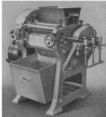
Abb. 146. Seifenflockenwalzwerk (Aug. Krull).
