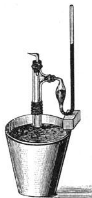
Abb. 9. Das Manometer zur Abmessung des Wurzeldrucks (vgl. auch Abb. 8). (Nach PFEFFER.)
