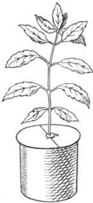
Abb. 13. Das zur Bestimmung der Transpirationsgröße dienende Zinkgefäß mit einem halbierten Deckel (vgl. S. 63).
