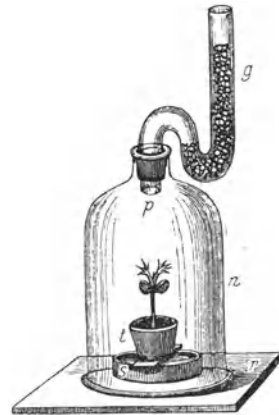
Abb. 32. Versuch zum Beweis, daß die grüne Pflanze auch im Lichte keine Stärke bildet, wenn sie keine Kohlensäure zur Verfügung hat. t die Versuchspflanze, s Kalilauge, n eine Glasglocke, r ein geschliffenes Glasbrett, pg ein mit Ätzkali gefülltes Glasrohr. (Nach PFEFFER.)
