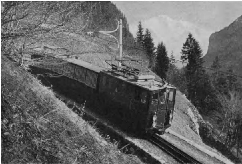
Abb. 95. Zug der Schynige-Platte-Bahn mit offenen Personenwagen.
