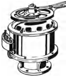
Abb. 137. Ruhender Drehstrommotor mit verstellbarem Rotor.
