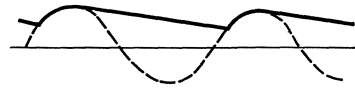
Abb. 25. Spannungsmesser nach Craighead. — — — zu messende Spannung, — Spannung am Kondensator bei schwacher Stromentnahme.
