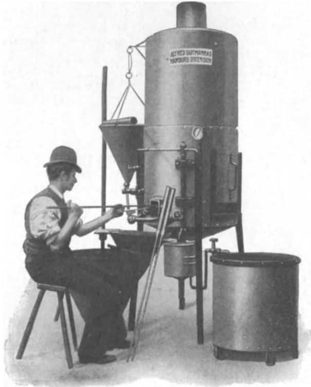
Abb. 8. Kleineres Sandschlammgebläse zum Abgraten gehauener und zum Nachschärfen stumpfer Feilen der Firma Alfred Gutmann A.-G. Ottensen-Hamburg.
