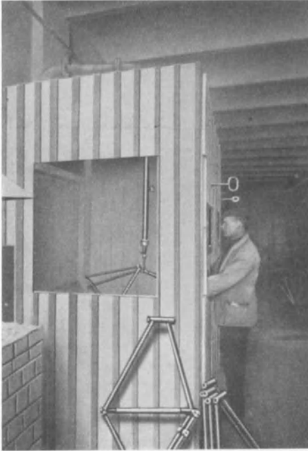
Abb. 19. Blasgehäuse nach dem Drucksystem mit von außen verstellbarer Blasdüse für sperrige Gegenstände der Alfr. Gutmann A.-G. Ottensen-Hamburg.
