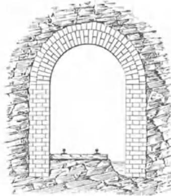
Abb. 120. Scheibenmauern (1 1/2 Stein stark) mit Halbkreisgewölbe.
