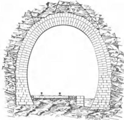
Abb. 125. Elliptisches Gewölbe auf geböschten Scheibenmauern.
