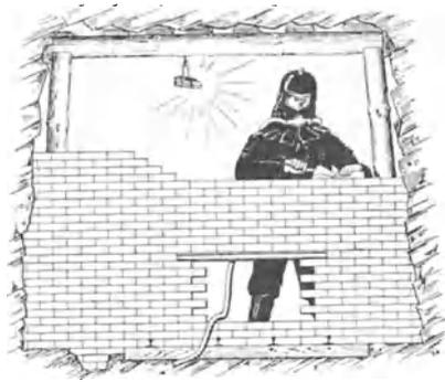
Abb. 840. Herstellung eines Mauerdammes mit Mannloch unter Verwendung eines Druckschlauch-Atmungsgerätes.
