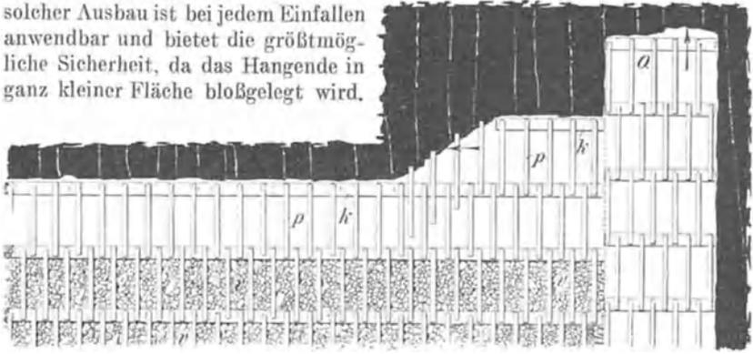
Abb. 80. Vortreibezimmerung im Abbau, Verhieb gleichlaufend mit dem Stoß (Pfundungsbau). (Die weißen Linien in der Kohle deuten die Schlechten an.)
