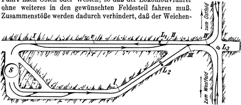
Abb. 607. Füllort für Durchschiebebetrieb mit Stellwerk.
