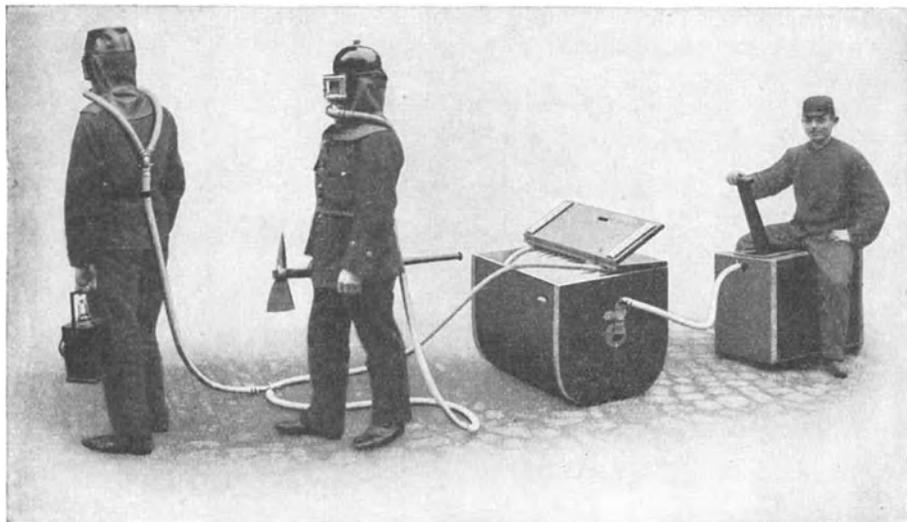
Abb. 846. Druckschlauch-Atmungsgeräte der Firma C. B. König in Altona.
