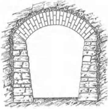
Abb. 119. Geböschte Scheibenmauern aus Bruchsteinen mit Ziegel-Gewölbekappen.
