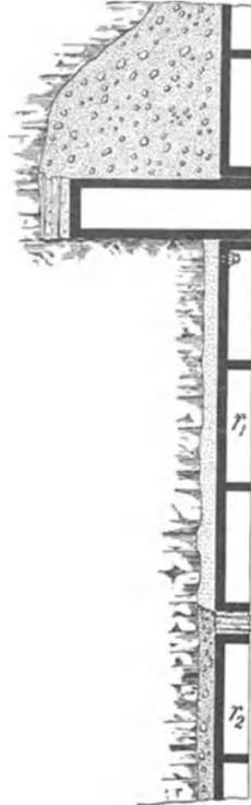
Abb. 232. Anschluß-Verkeilung zwischen zwei Gußringen.
