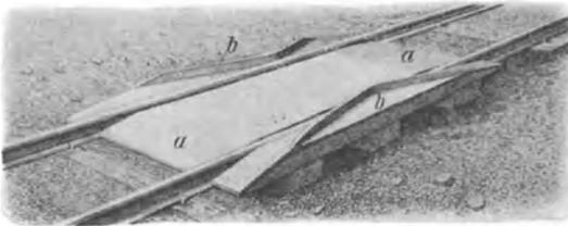
Abb. 514. Aufgleisplatte.
