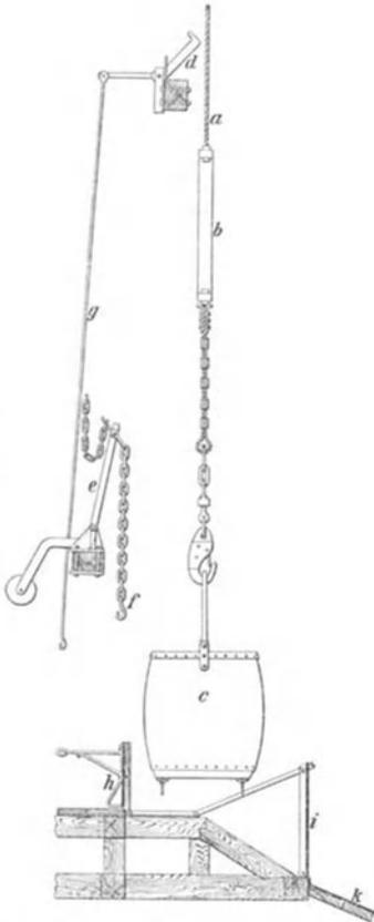
Abb. 264. Kübelkippvorrichtung: Kübel am Seile hängend.
