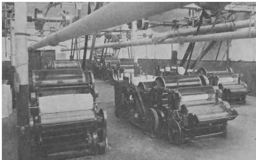
Abb. 55. Schlagmaschine mit Wickelvorrichtung (Rich. Hartmann A.-G., Chemnitz).
