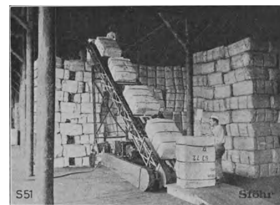
Abb. 15. Höhenstapler für Baumwollballen u. dgl. (Wilhelm Stöhr, Offenbach a. M.).
