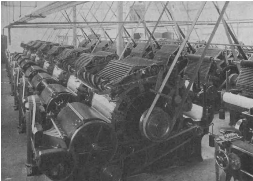
Abb. 65. Krempelsaal, Deckelkrepeln mit Riemenantrieb (Rich. Hartmann A.-G., Chemnitz).
