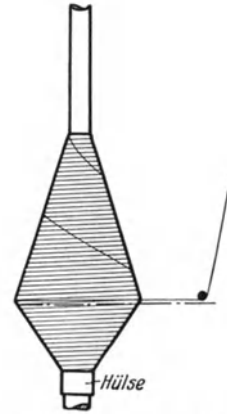
Abb. 127. Copansatz mit Leiteschiene gewunden, deren Höhepunkt sehr niedrig steht.
