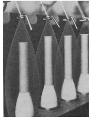
Abb. 136. Ausbildung des Ballons beim Winden auf großen Durchmesser.
