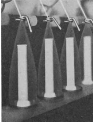
Abb. 135. Ausbildung des Ballons beim Winden auf kleinen Durchmesser.
