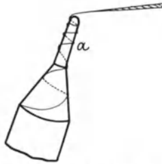
Abb. 124. Fadenwindung auf der Spindel Spitze (aus: Rohn, Spinnerei).
