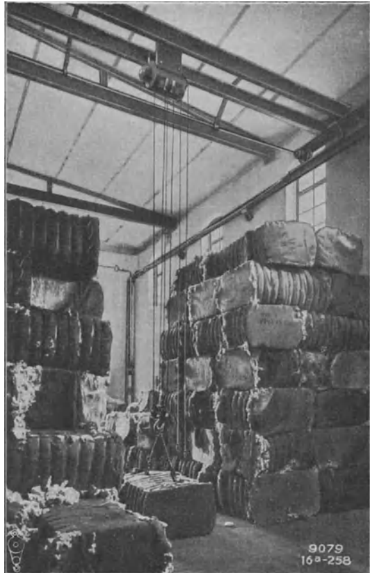
Abb. 11. Demag-Zug als Hubwerk in einem Handlaufkran.
