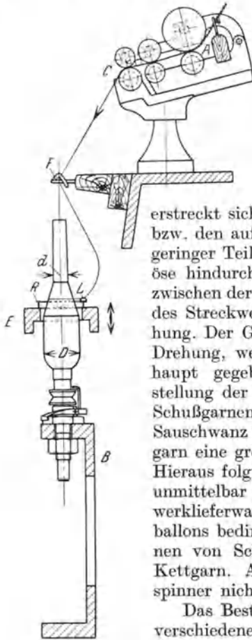
Abb. 132. Elemente eines Ringspinners (Streckwerk, Fa- denföhler, Ring- bank, Spindel). Mit Gen. d. BBC, Mannheim.
