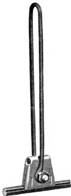
Abb. 65. Fahrdrahtklemme mit lockerem Hänger.
