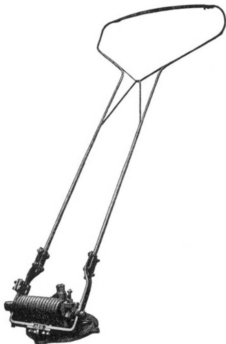
Abb. 394. Bügelstromabnehmer mit drehbarem Federbock (AEG).
