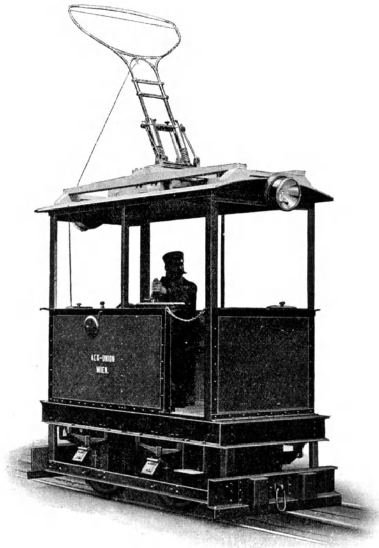
Abb. 440. Obertag-Lokomotive für eine Industriebahn. Achsfolge 2 A. 2 Motoren innenliegend (AEGU).
