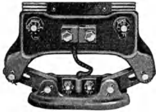
Abb. 403. Stromabnehmer für Stromschiene, Berührungsdruck durch Eigengewicht erzeugt.
