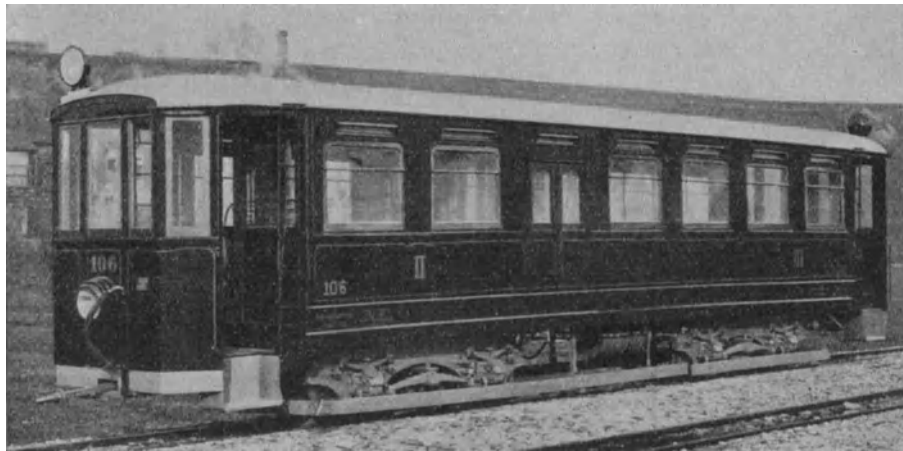
Abb. 419. Vierachsiger Triebwagen für die Überlandbahn M. Ostrau—Karwin. Doppelte Federung, tragfähige Fenstersäulen, Tonnendach (OSSW).
