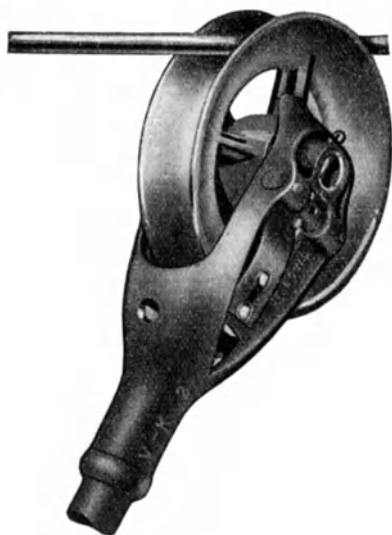
Abb. 384. Stangenkopf mit Stromabnehmerrolle.
