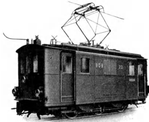
Abb. 389. C-b-Lokomotive der Perner-Oberland-Bahn. 800/500 PS, 1500 V. Doppelscherenstromabnehmer mit doppelten Vierkantbügeln (MFO).
