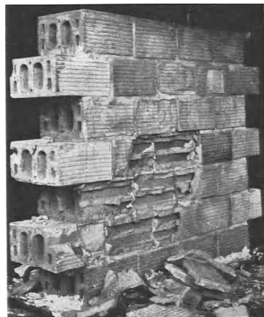
Bild 5. Mauerwerkskörper mit H = 2 \sqrt{\bar{F}} gemäß Verband I
