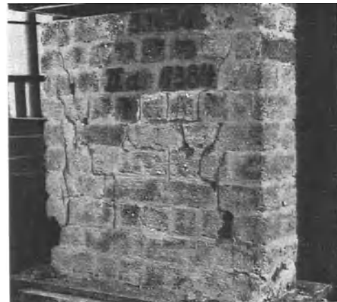
Bild 4. Mauerwerkskörper mit H = 2 \sqrt{\bar{F}} gemäß Verband IV
