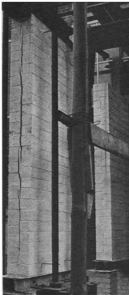
Bild 8. Mauerwerkskörper mit H = 3 m gemäß Verband VII
