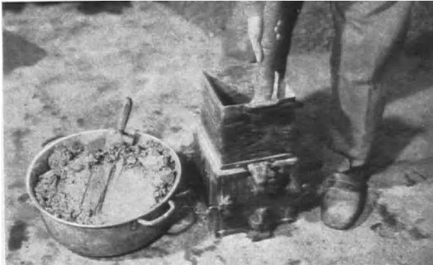
Bild 7. Einrüttlung einer erdfeuchten Betonmischung
