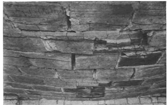
Bild 13. Decke IIa ohne Vorwurf, geputzt mit Schamottemörtel + Zement; Unterseite nach dem Brand
