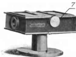
Abb. 4. Inklinatorium. Länge der Nadel 20 cm.
