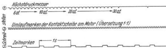
Abb. 308. Ausschnitt aus einem Schreibstreifen des Höchstdruckmessers.
