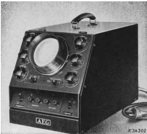
Abb. 151. Kathodenstrahl-Oszillograph der AEG. (Eon IV, für Netzanschluß 220 V, 50 Hz, Abmessungen: 300 × 290 × 350 mm<sup>3</sup>.)
