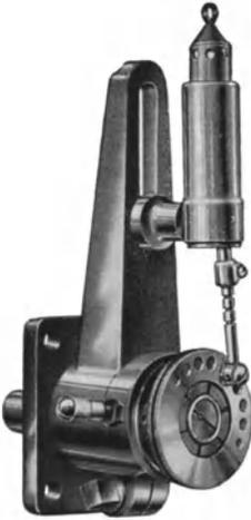
Abb. 65. Hubverminderer von Lehmann & Michels für den Schnellläuferindikator, mit einstellbarem Treibstangenverhältnis  $z/r$  und einstellbarer Phasenstellung.
