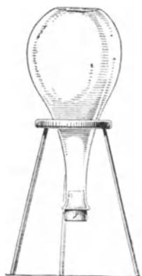
Abb. 41. Zusammenbruch einer Flasche unter dem Druck der Atmosphäre.
