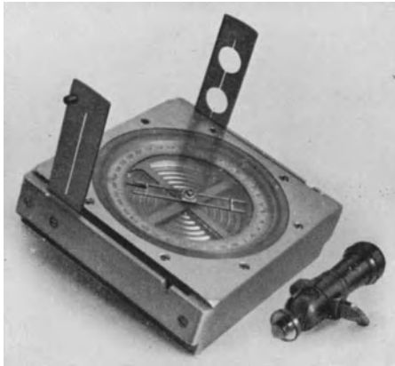
Abb. 7. Danckelmannscher Routenfluidkompaß der Firma Ed. Sprenger in Berlin.
