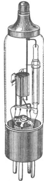
Abb. 20. Die Elektrometerröhre AEG- Osram T 114; Gitterstrom bis 10^{-14} A. Die Röhre hat allerdings kleinere Steilheit und größeren Durchgriff als die Type T 113.
