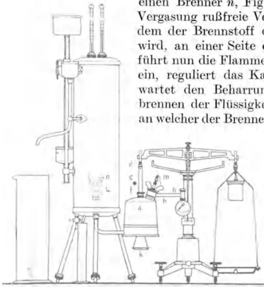
Fig. 315. Aufbau des Junkers-Kalorimeters für flüssigen Brennstoff.
