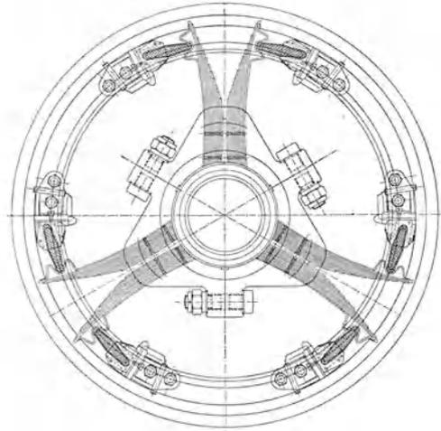
Abb. 29. Antriebsapparat zu den Drehstrom-Achsmotoren von 375 PS bei 895 Uml/min der A. E. G. für die Schnellwagen Berlin-Zossen. — 1:20.
