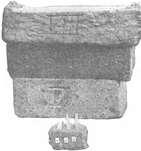
Bei Segerkegel 16 unter Belastung auf ihren Erweichungsgrad geprüfte Koksofensteine.
