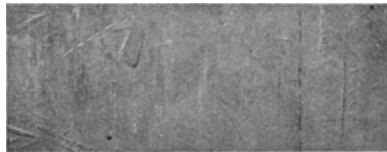
Abb. 264. Das Messingblech nach 800 Stunden ohne Schutz v = 2 Abb. 265. Das Messingblech nach 800 Stunden mit Schutz v = 2 bei sonst gleichen Versuchsbedingungen.
