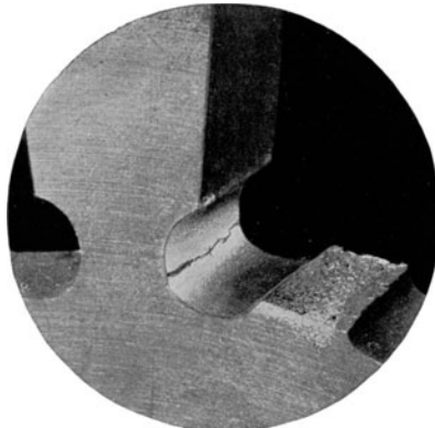
Abb. 32. Bruch eines Belastungszahnes am Modellversuchskörper Nr. 1.
