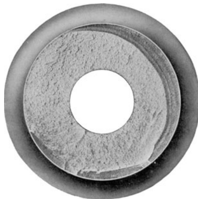
Abb. 69. Anriß einer Welle infolge Schmiedefehlers.
