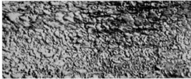
Abb. 212. Kleinere, glänzende Anfrassungen. Ursprüngliche Oberfläche der inneren Rohrwand nicht mehr vorhanden. Große Stromdichte!
