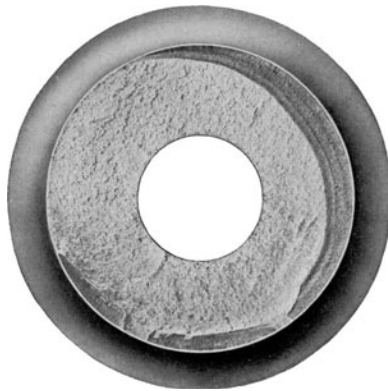
Abb. 198. Anriß einer Welle infolge Schmiedefehlers.
