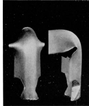
Abb. 146a. Profilierter Nickelstahl, 25 v. H. Ni. Laufschaufeln aus demselben Rad, entnommen, noch völlig gesund.
