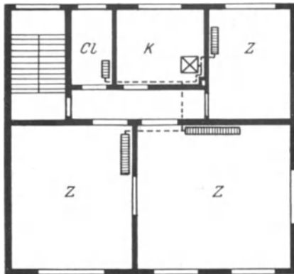
Abb. 142. Heizkörper an den Innenwänden.
