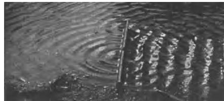
Abb. 206. Beugung von Wasserwellen an einem Loch. (Nach GRIMSEHL.)
