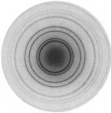
Abb. 588. Elektronenbeugung in einer Metallfolie. (Aufnahme von H. MARK.)
