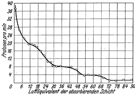
Abb. 9. Absorptionskurve der Rückstoßprotonen aus Neutronen aus Be + (RaEm + RaA + RaC).
