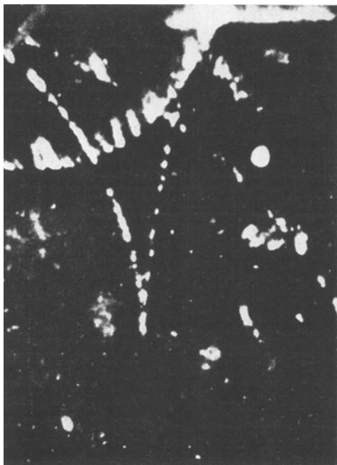
Abb. 20. „Zwillingspaar“ (Elektron und Positron) durch von unten kommende \gamma -Strahlung erzeugt.
