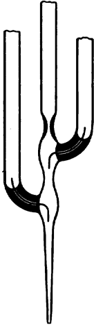
Abb. 26. Zelle zur Bestimmung der elektrischen Leitfähigkeit kleiner Elektrolytmengen nach LEWIS und DOODY (137).
