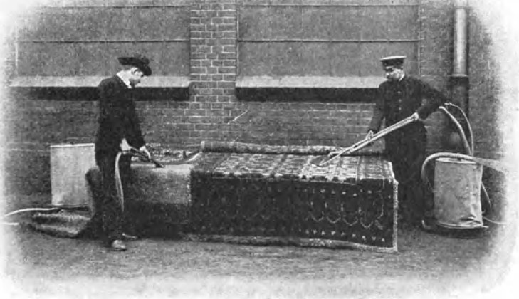
Abb. 23. Wirkungsweise des Druckluftsaugers.
