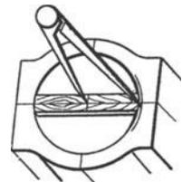
Abb. 81. Durch Einsetzen eines Mittelabstandes zum Anreißen vorbereitetes Werkstück.
