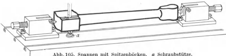
Abb. 105. Spannen mit Spitzenböcken. a Schraubstütze.
