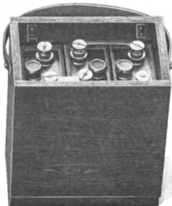
Fig. 78. Zündbatterie für 4 Volt. 3 Edisonzellen Type Kf 12/5, Kapazität 16 Amp.-Std., eingebaut in Holzkasten.
