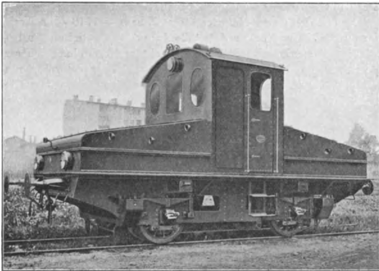
Fig. 75. Mit Edisonakkumulatoren betriebene Lokomotive, gebaut von den Schichauwerken, Elbing.
