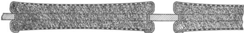
Fig. 7. Maßstab 4 : 1. Querschnitt durch die in vernickelte Eisenplatte eingepreßte, mit aktivem Material gefüllte Tasche einer Edisonzelle.
