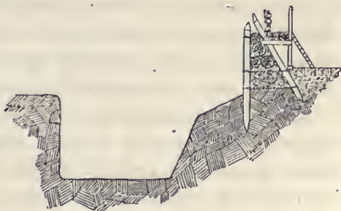
Przekrój przez rów i ostrołukowe utwierdzenie w zameczku polskim. (Odtworzenie Kazimierza i Tadeusza Mokłowskich).
