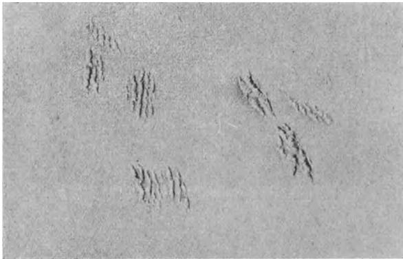
Abb. 9. Ausstoßschaden auf der Narbenseite eines unzugewandten Bor-
