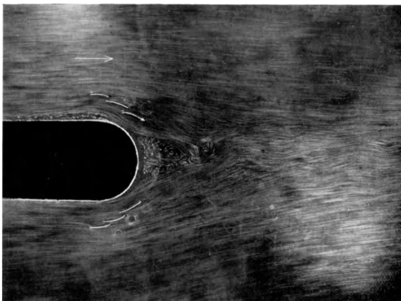
Abb. 27. Verkleinerung der Wirbelzone hinter stumpf endigendem Hindernis mittels Leitflächen.
