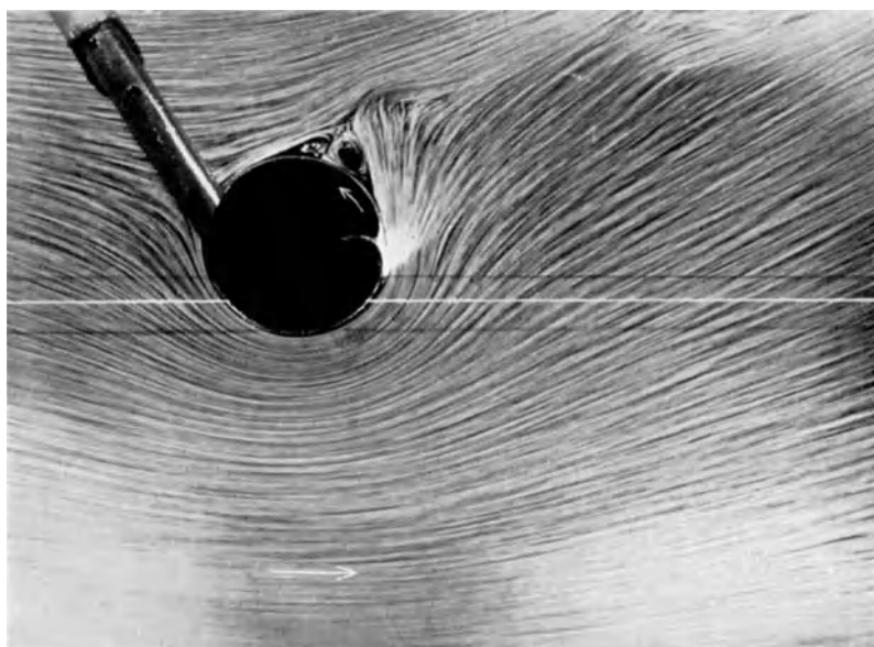
Abb. 20. Unterdrückung der Ablösung durch Grenzschichtabsaugung.
