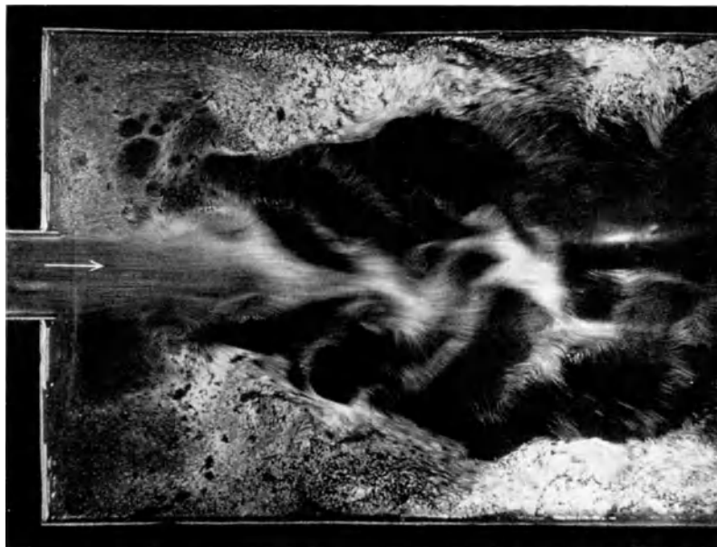
Abb. 16. Mischbewegung zwischen Treibstrahl und ruhender Flüssigkeit bei größeren Geschwindigkeiten.
