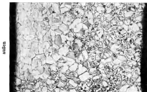
Abb. 6. Querschnitt durch die Wand eines Rohres mit Entzinkung, von der Innenseite netzförmig eindringend. V=50 .
