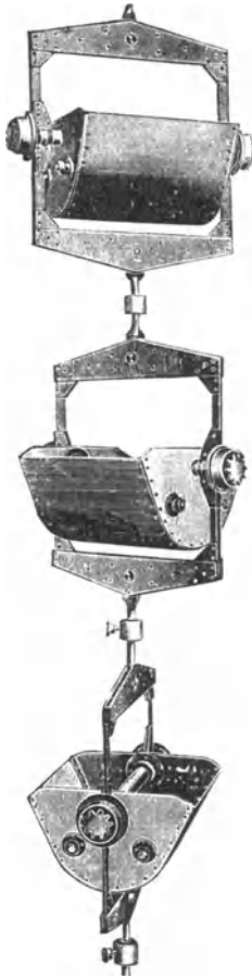
Abb. 351. Kurvenbewegliche und verdrehbare Becherkette (Schenck).
