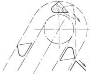
Abb. 246. Becherentleerung beim langsamlaufenden Elevator.
