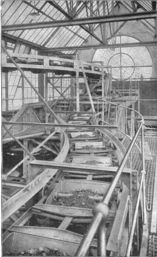
Abb. 347. Becherwerk von Schenck in der Kurve.
