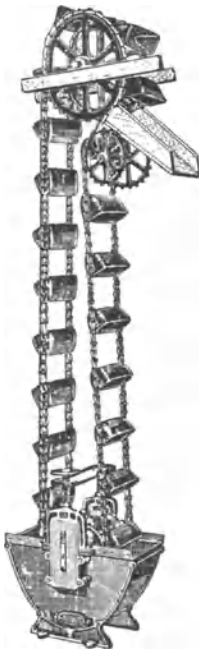
Abb. 247. Elevator mit Ablenkung des niedergehenden Stranges.
