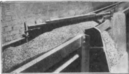
Abb. 157. Stahlband zur Förderung von 50 t/st Rohsalz mit einseitigem Abstreicher (Sandviken).
