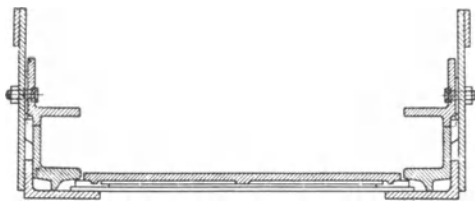
Abb. 107. Querschnitt der Brouwer-Rinne (neuere Bauart).
