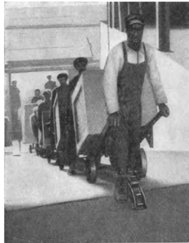
Abb. 136. Schleppkette für Karrenförderung (Otis).
