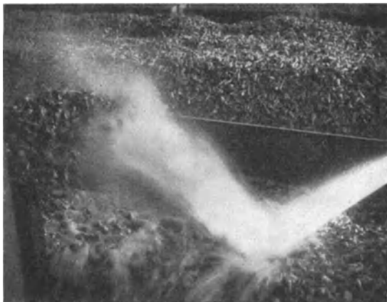
Abb. 437. Abschwemmen von Rüben nach dem Elfa-Spülverfahren.
