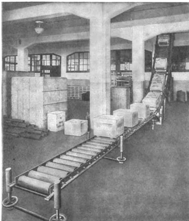
Abb. 376. Rollbahn zur Beförderung von Kisten in einer Nähmaschinenfabrik (Siegerin-Goldman-Werke).
